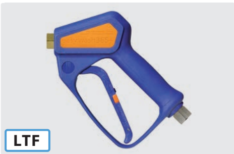
Professionelle Pistole. Weepausführung. Max. 310 bar / 45 l/min / 150 °C
