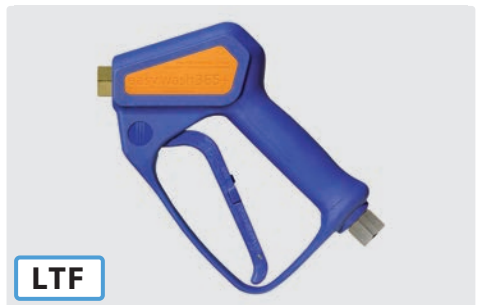
Professionelle Pistole. Frostschutzausführung. Max. 310 bar / 45 l/min / 150 °C
