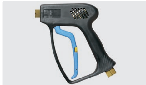
Professionelle Pistole. Weepausführung. Max. 275 bar / 45 l/min / 150 °C
