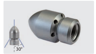
3/8" IG. Außen \varnothing 30 mm. Bohrungen hinten, 1 Bohrung vorn
