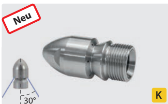
M22x1,5 AG. Außen \varnothing 25 mm. Bohrungen hinten
