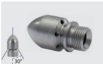
1/2" AG. AGR Dichtkonus. Außen \varnothing 30 mm. Bohrungen hinten, 1 Bohrung vorn
