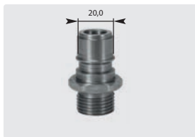
Stecknippel : AG. Edelstahl ungehärtet. Max. 250 bar / 150 °C
