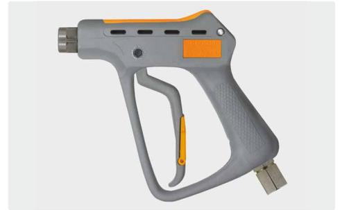
Professionelle High-Flow Pistole. Edelstahl. Industrielle Hochdruckreinigungs- und Spülpistole für den Bereich Kommunaltechnik, Kanalreinigung und Industrie. Ventilkolben aus gehärtetem Edelstahl. Max. 350 bar / 200 l/min / 150 °C
