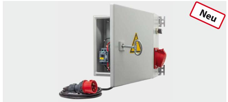
Steuerkasten, IP 66, RAL 7035. H x B x T 300 x 300 x 155 mm. Mit Einspeisung 2 m Leitung mit CEE-Stecker, 16 A, 400 V AC, 50 HZ, 3 Ph/N/PE. Steuerspannungsaufbereitung 24 V AC, 20 VA mit 2 Sicherungsautomaten. Motorabgang mit Leistungsschütz 7,5 kW, verdrahtet auf CEE-Anbaugehäuse. Mit Zeitrelais zur Impulsverlängerung 0,05 s - 10 h. Ohne Steuerleitung
