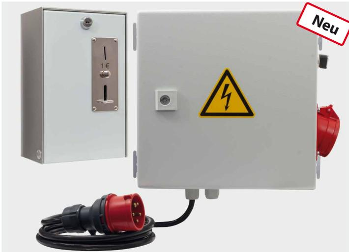
R+M Münzautomat, mechanisch mit Geldrückgabe inkl. Steuerkasten, IP 66, RAL 7035 mit Einspeisung 2 Meter Leitung mit CEE-Stecker, 16 A, 400 V AC, 50 HZ, 3 Ph/N/PE. Steuerspannungsaufbereitung 24 V AC, 20 VA mit 2 Sicherungsautomaten. Motorabgang mit Leistungsschütz 7,5 kW, verdrahtet auf CEE-Anbaugehäuse. Mit Zeitrelais zur Impulsverlängerung 0,05 s - 10 h. Ohne Steuerleitung
