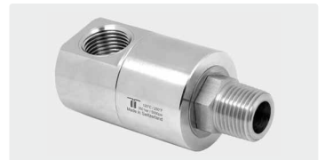
DGEI 90°. Gehäuse Edelstahl. 3-fach gelagert. Max. 350 bar
