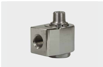
1/4" IG : 1/4" AG. DN 7. Max. 150 bar / 30 U/min / 90 °C
