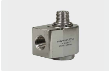
1/4" IG : 1/4" AG. DN 7. Max. 275 bar / 30 U/min / 120 °C
