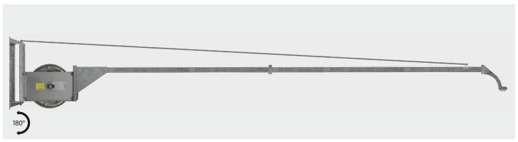
Stahl verzinkt. Ausleger mit Schlauchtrommel ST 14 aus Edelstahl. Schlauchkapazität Außen  $\bigcirc$  = Schlauch  $\bigoplus$  15 mm = 14 m . 20 mm = 12 m. Ohne Hochdruckschlauch. Max. 300 bar.
