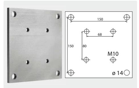
Für Decken- oder Wandmontage. Edelstahl. 180 x 180 mm. Stärke 8 mm. 4 x M10 zur Aufnahme des Wand- und Deckenkreisels
