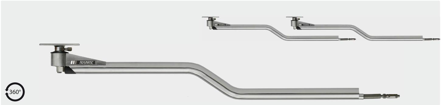
Edelstahl. Montagefertig für die Installation mit 2 integrierten Qualitätsdrehgelenken. Speziell für den Einsatz von 2 Deckenkreiseln nebeneinander geeignet. Hochdruckschlauch mit Isolierung. Max. 275 bar / 90 °C.
