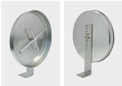
Polierter Edelstahl. Zubehör für automatische Waschanlagen. Schnellläufer Drehgelenk. Rotorarm wird durch Wasser angetrieben. Höhenverstellbar. Anschluss über einen Schlauch des Pumpensystems. Es werden 4 Düsen mit 1/8" AG NPT benötigt. Rotor  $\varnothing$  470 / 350 mm. Max. 250 bar / 2.000 U/min / 120 °C
