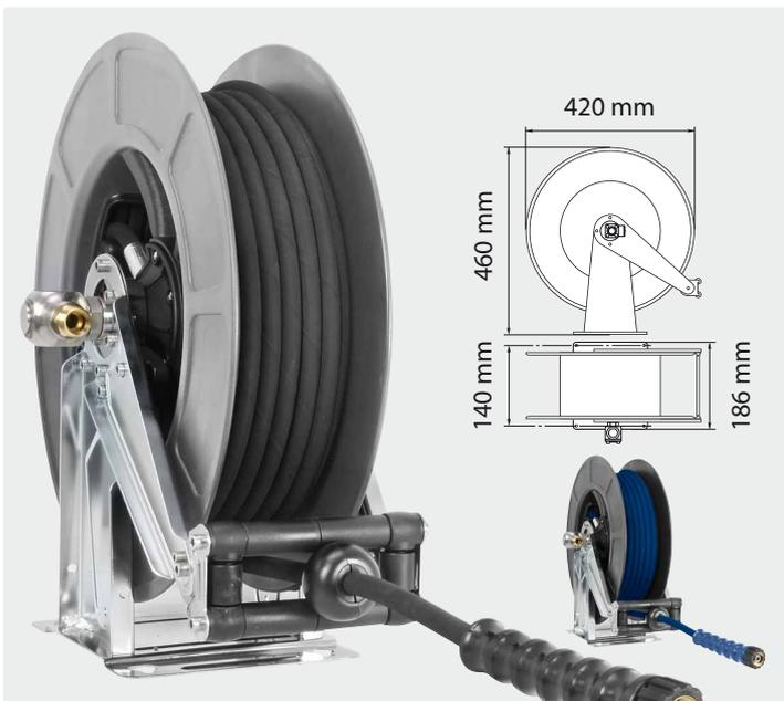
**Schlauchaufroller:** Gestell aus Edelstahl V2A / AISI 304. Trommel aus besonders schlagfestem ABS Kunststoff, mit automatischem Federzug und Zugentlastung. Suttner Drehgelenk ST-322 aus Edelstahl. Max. 90 °C
