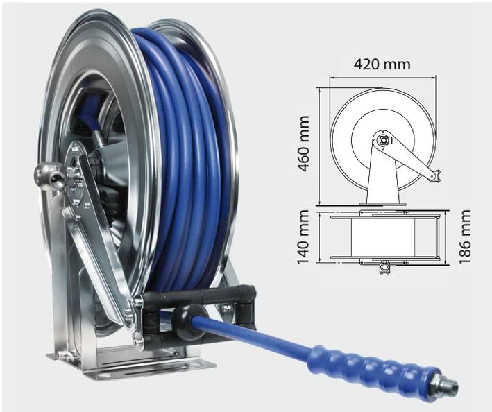
**Schlauchaufroller:** Edelstahl V2A / AISI 304. Mit automatischem Federzug und Zugentlastung. Suttner Drehgelenk ST-322 aus Edelstahl. Max. 90 °C
