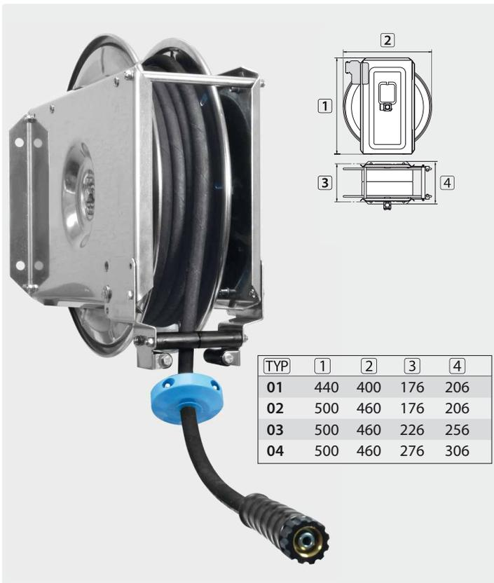
**Schlauchaufroller:** Edelstahl V2A / AISI 304. Der Schlauch kann in jeweils 8 Rastenstellungen pro Umdrehung arretiert werden. Ein kurzer Zug am Schlauch hebt die Arretierung wieder auf. Suttner Drehgelenk ST-322 aus Edelstahl. Max. 90 °C
