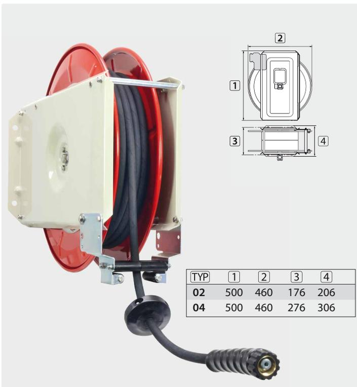
**Schlauchaufroller:** Stahl pulverbeschichtet. Der Schlauch kann in jeweils 8 Rastenstellungen pro Umdrehung arretiert werden. Ein kurzer Zug am Schlauch hebt die Arretierung wieder auf. Suttner Drehgelenk ST-322 aus Edelstahl. Einsatz in trockener Umgebung. Max. 90 °C
