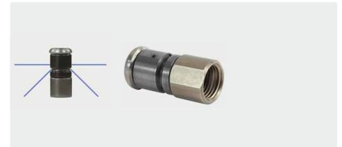
1/8" IG. Düse mit Zugwirkung. Rostfreier Edelstahl. Gehärteter Edelstahlrotationskörper. Kompakte Bauform, für universellen Einsatz. Extrem hohe Reinigungsleistung. ⊙ 12 mm. Max. 500 bar
