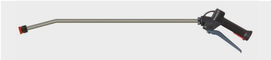
600 mm. Chemiepistole mit Lanze aus Edelstahl und Düsenhalter ohne Düse. Pistole mit chemiebeständiger Edelstahlkugel V4A / AISI 316. Max. 25 bar / 30 l/min / 50 °C
