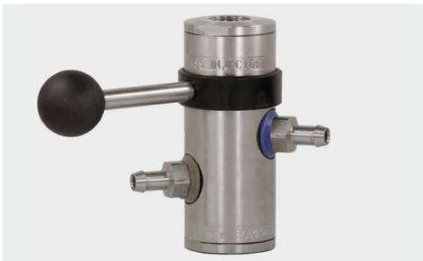
1/2" IG : 1/2" IG. Injektor mit Tülle 9 mm und Druckluftmodul (Tülle 9 mm). Regulierung der Chemiedosierung erfolgt durch 10 auswechselbare Dosiereinsätze (0,5 - 2,0 mm).
