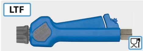
Professionelle Pistole mit Abschaltverzögerung, Öffnungsarretierung und Kupplung ST-3100. Edelstahl. Anwendung z. B. Schaum- und Spülanwendungen in der Lebensmittelindustrie. Industriestandard. Max. 24,5 bar / 120 l/min / 100 °C
