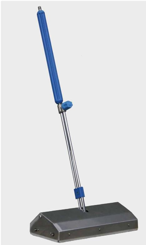
Edelstahl. Stufenlose Druckregulierung. Niederdruckphase für Chemieansaugung. Inkl. 4 Düsen 80° 015. Breite 400 mm. Max. 250 bar / 21 l/min / 80 °C
