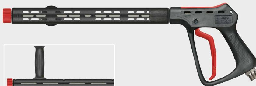
Professionelle Höchstdruckpistole mit Verlängerung ST-9 380 mm, Handgriff und HV M22. Max. 500 bar / 80 l/min / 150 °C
