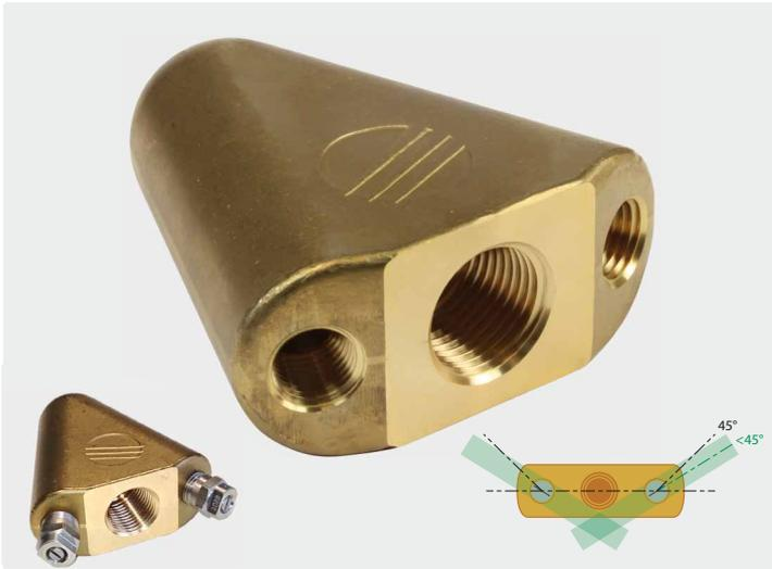
Als Träger für 2 Flachstrahldüsen. Empfohlener Spritzwinkel 15°. Die Flunderdüse ist die Standardlösung für das Freispülen von Ablagerungen. Die schwere, geschmiedete Messingausführung hält den Strahl in der Nähe der Schmutzansammlungen am Boden und befördert diese zur Einstiegsöffnung.
