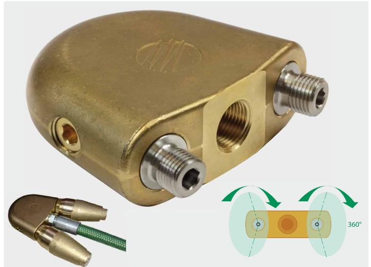
Als Träger für 2 Rotordüsen ST-357. Die Flunderdüse ist die ideale Lösung für das Freispülen von festsitzenden Ablagerungen. Durch die rotierenden Strahlen wird die Spülwirkung bei unter Wasser stehenden Rohrleitungen vervielfacht. Die schwere, geschmiedete Messingausführung hält den Strahl in der Nähe der Schmutzansammlungen am Boden und befördert diese zur Einstiegsöffnung.
