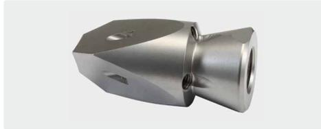
350 bar. 1/4" IG.  $\square$  50 mm,  $\varnothing$  = 25 mm,  $\boxtimes$  0,13 kg. Für Rohre > 30 mm. Seitliche Frontstrahlen 0,5 mm gebohrt.
