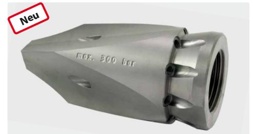
300 bar. 1" IG.  $\square$  100 mm,  $\varnothing$  = 50 mm,  $\boxtimes$  0,64 kg. Für Rohre > 100 mm. Seitliche Frontstrahlen mit gehärteten Edelstahl Düseneinsätzen.
