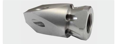
350 bar. 3/8" IG.  $\square$  55 mm,  $\varnothing$  = 28 mm,  $\boxtimes$  0,13 kg. Für Rohre > 50 mm. Seitliche Frontstrahlen mit gehärteten Edelstahl Düseneinsätzen.
