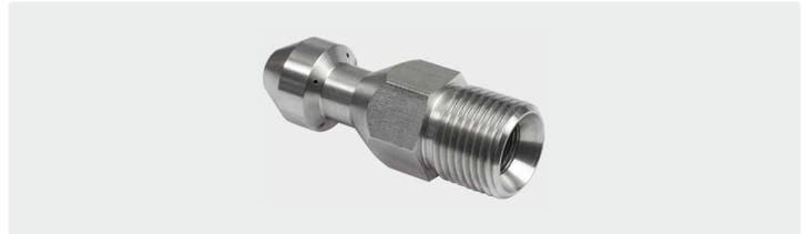
Rohrreinigungsdüse für Standard-Anwendungen. 4 Bohrungen hinten (30°) für gute Zugwirkung. Frontbohrung zum Durchbrechen von Verstopfungen oder Enteisen. Konische Spitze für enge Rohrbögen und Vorsprünge.
