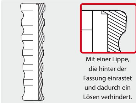
Mit einer Lippe, die hinter der Fassung einrastet und dadurch ein Lösen verhindert.
