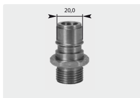
Stecknippel : AG. Edelstahl ungehärtet. Max. 250 bar / 150 °C
