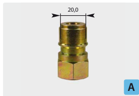
Stecknippel : IG. Stahl verzinkt. Max. 250 bar / 150 °C
