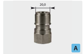
Stecknippel : IG. Edelstahl gehärtet. Max. 250 bar / 150 °C
