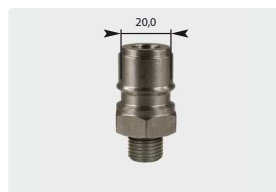
Stecknippel : AG. Edelstahl gehärtet. Max. 250 bar / 150 °C
