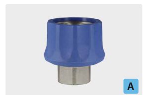
Kupplung : IG. Messing vernickelt. Max. 250 bar / 150 °C
