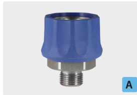
Kupplung : AG. Edelstahl. Max. 250 bar / 150 °C
