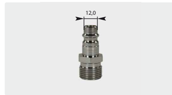
Stecknippel : AG. Ø 12 mm. Stahl vernickelt. Max. 200 bar / 100 °C
