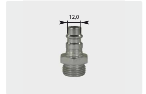
Stecknippel : AG. \varnothing 12 mm. Stahl vernickelt. Max. 250 bar / 100 °C
