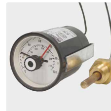
1/2" AG. Kontakt 5 A - 250 V (AC1). Temperaturanzeige 0 - 120 °C
