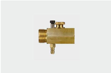
Injektor mit zu- und abschaltbarer Chemiedosierung. Zur Ansaugung von Chemie im Wassereingang der Pumpe. Chemie/Wassergemisch kann somit im Hochdruckbetrieb aufgetragen werden. Rückflussverhinderer (R+M Nr. 734 10) verwenden. Tülle 6 mm. Max. 10 bar / 90 °C
