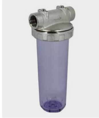
3-teilig. Entlüftungsstopfen. Kopf Messing vernickelt. Tasse Kunststoff. Max. 15 bar / 40 °C
