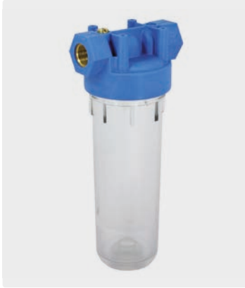
2-teilig. Entlüftungsstopfen. Innengewinde Messing. Max. 10 bar / 50 °C
