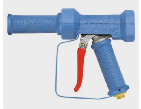
Pistole mit stufenloser Spritzwinkelveränderung. Sicherungsbügel. Max. 24 bar / 100 l/min / 95 °C
