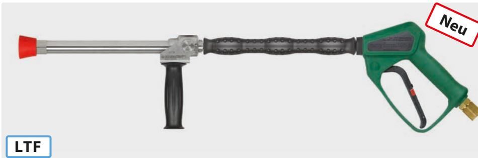
1/2" IG. Edelstahl. Weitwurflanze 350 mm mit Isolierung ST-29 Cool & Compact 330 mm, Pistole **easyfarm365+**, seitlichem Handgriff und Düsenschutz aus Kunststoff ohne Düse.
