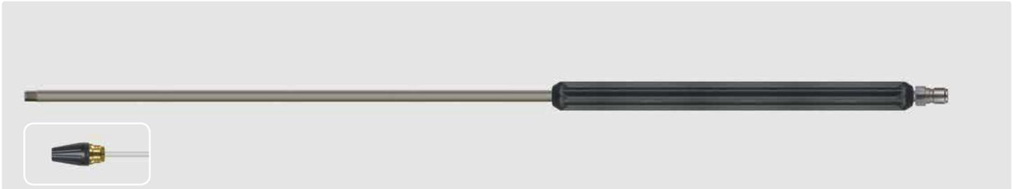
Stecknippel ST-3100. Strahlrohr aus Edelstahl, umspritzte Isolierung 400 mm und 1/4" AG Anschluss für Rotordüsen. Strahlrohre werden ohne Rotordüsen geliefert. Max. 400 bar / 150 °C
