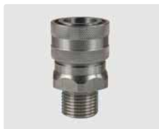
Kupplung : AG. Edelstahl. 60° Dichtkonus. Max. 250 bar / 150 °C
