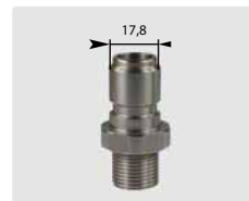
Stecknippel : AG. Edelstahl. 60° Dichtkonus. Max. 250 bar / 150 °C
