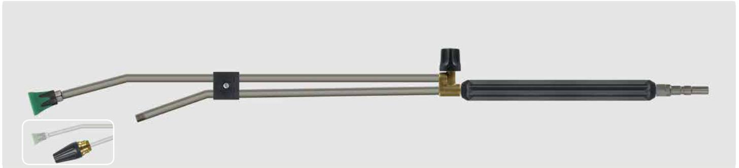
Stecknippel KW. Strahlrohr aus Edelstahl, umspritzte Isolierung 300 mm, Ventil ST-53 oben, Düsenschutz ST-10 mit Niederdruckdüse und 1/4" AG Anschluss für Rotordüsen. Strahlrohre werden ohne Rotordüsen geliefert. Max. 250 bar / 150 °C
