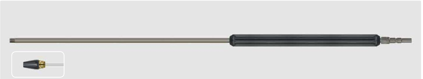
Stecknippel KW. Strahlrohr aus Edelstahl, umspritzte Isolierung 400 mm und 1/4" AG Anschluss für Rotordüsen. Strahlrohre werden ohne Rotordüsen geliefert. Max. 400 bar / 150 °C
