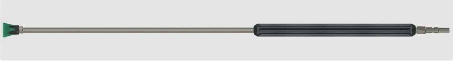
Stecknippel KW. Strahlrohr aus Edelstahl, umspritzte Isolierung 400 mm und Düsenschutz ST-10 ohne Düse. Max. 400 bar / 150 °C
