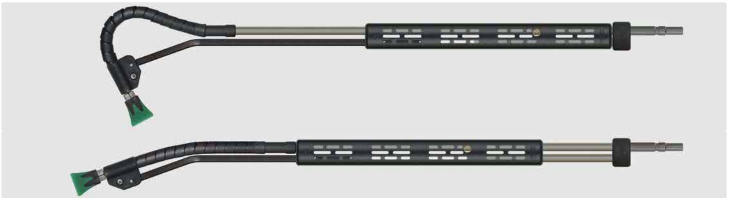
Stecknippel KW. Strahlrohr aus Edelstahl, Isolierung ST-9 380 mm und Düsenschutz ST-10 ohne Düse. Stufenlose Verstellung des Biegewinkels der Lanze von 20 - 140°. Sie erreichen jeden Winkel ohne Verrenkungen und mühelos. Max. 210 bar / 150 °C
