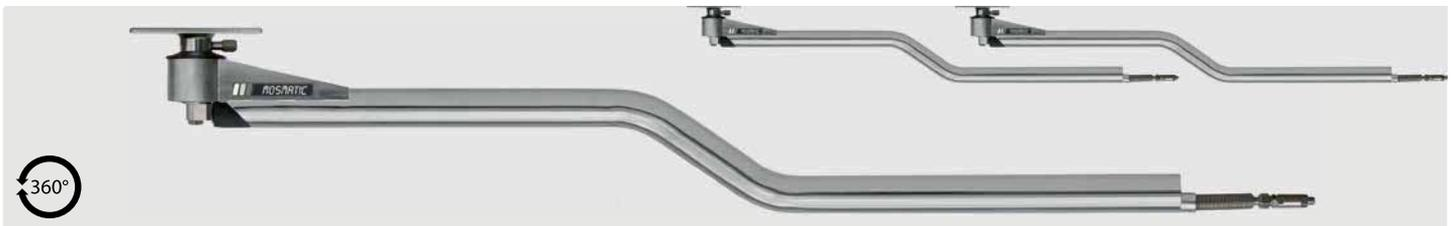
Edelstahl. Montagefertig für die Installation mit 2 integrierten Qualitätsdrehgelenken. Speziell für den Einsatz von 2 Deckenkreiseln nebeneinander geeignet. Hochdruckschlauch mit Isolierung. Max. 275 bar / 90 °C.
