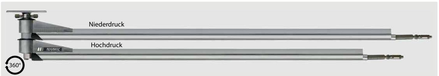
Edelstahl. Montagefertig für die Installation mit 3 integrierten Qualitätsdrehgelenken, professionellem Hochdruckschlauch mit Zugentlastungsfeder sowie integriertem Knickschutz. Achse 2-fach gelagert sowie permanent geschmiert. Speziell für 2 unterschiedliche Medien und Anwendungen entwickelt. Max. 275 bar / 90 °C. **Achtung: Lieferzeit ca. 2 Wochen!**
