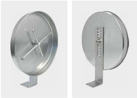
Poliertes Edelstahl. Zubehör für automatische Waschanlagen. Schnellläufer Drehgelenk. Rotorarm wird durch Wasser angetrieben. Höhenverstellbar. Anschluss über einen Schlauch des Pumpensystems. Es werden 4 Düsen mit 1/8" AG NPT benötigt. Rotor  $\varnothing$  470 / 350 mm. Max. 250 bar / 2.000 U/min / 120 °C
