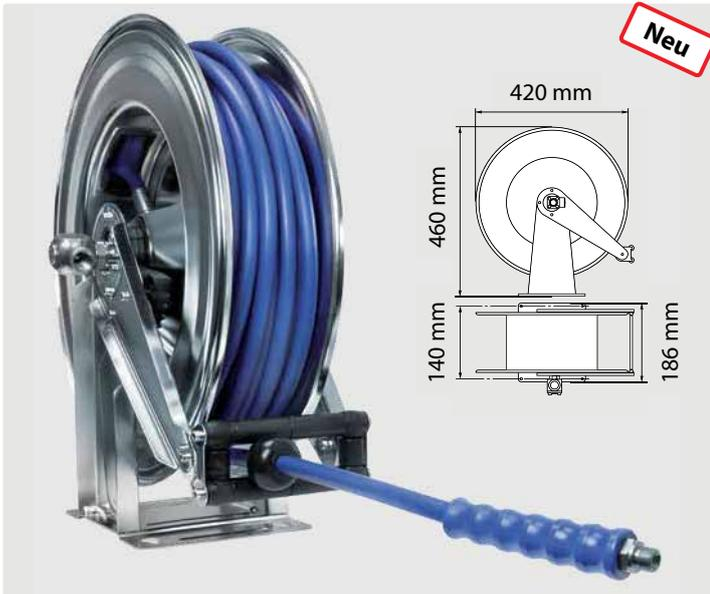
**Schlauchaufroller:** Edelstahl V2A / AISI 304. Mit automatischem Federückzug und Zugentlastung. Suttner Drehgelenk ST-322 aus Edelstahl. Max. 90 °C
