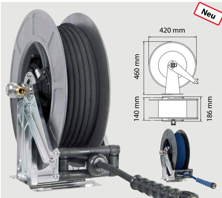
**Schlauchaufroller:** Gestell aus Edelstahl V2A / AISI 304. Trommel aus besonders schlagfestem ABS Kunststoff, mit automatischem Federückzug und Zugentlastung. Suttner Drehgelenk ST-322 aus Edelstahl. Max. 90 °C
