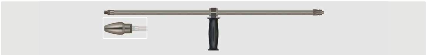
Stecknippel ST-45. Strahlrohr mit Handgriff für Rotordüsen mit 1/4" IG ohne Rotordüse. Max. 600 bar / 150 °C
