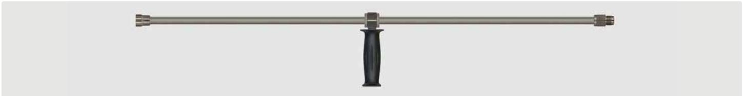
1/2" AG. Strahlrohr mit Handgriff und Muffe 1/4" IG aus Edelstahl ohne Hochdruckdüse. Max. 600 bar / 150 °C
