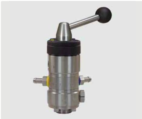
3/8" IG : 1/2" IG : 2 x Tülle 9 mm. Regulierung der Chemiedosierung erfolgt durch 2 x 10 auswechselbare Dosiereinsätze (0,5 - 2,0 mm). Max. 350 bar / 100 °C
