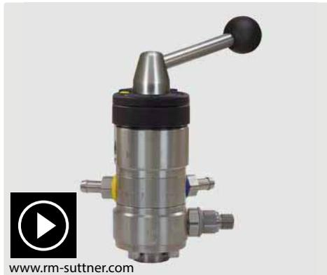
3/8" IG : 1/2" IG : 2 x Tülle 9 mm : Druckluftmodul (1/4" AG). Regulierung der Chemiedosierung erfolgt durch 2 x 10 auswechselbare Dosiereinsätze (0,5 - 2,0 mm). Max. 350 bar / 100 °C
