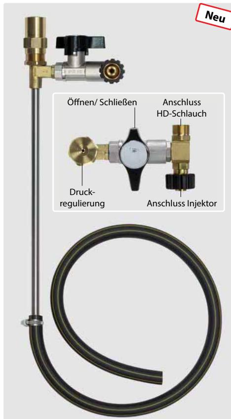
ST-230 mit Anschluss, Kugelhahn, Edelstahlrohr 400 mm und Schlauch 1.000 mm. Max. 250 bar / 30 l/min / 95 °C
