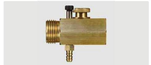
Injektor mit zu- und abschaltbarer Chemiedosierung. Zur Ansaugung von Chemie im Wassereingang der Pumpe. Chemie/Wassergemisch kann somit im Hochdruckbetrieb aufgetragen werden. Rückflussverhinderer (R+M Nr. 734 10 / 734 20) verwenden. Tülle 6 mm. Max. 10 bar / 90 °C
