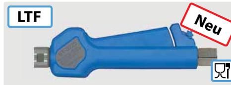
Professionelle Pistole mit Abschaltverzögerung und Öffnungsarretierung. Edelstahl. Anwendung z. B. Schaum- und Spülanwendungen in der Lebensmittelindustrie. Industriestandard. Max. 24,5 bar / 120 l/min / 100 °C
