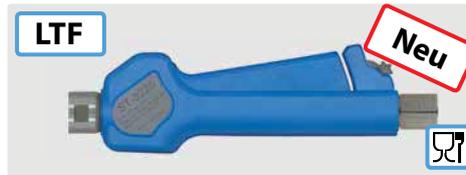
Professionelle Hochdruckpistole mit Abschaltverzögerung. Edelstahl. Anwendung z. B. Schaum- und Spülanwendungen in der Lebensmittelindustrie. Industriestandard. Max. 60 bar / 120 l/min / 100 °C
