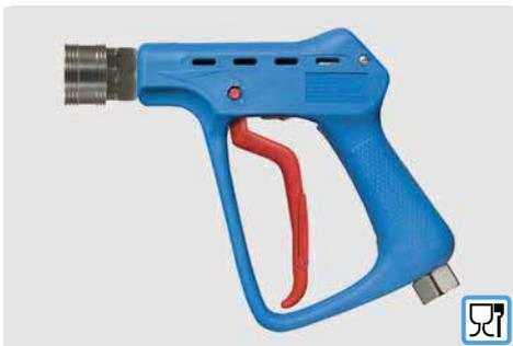
Professionelle High-Flow Pistole mit Kupplung ST-45. Edelstahl. Anwendung z. B. Schaum- und Spülanwendungen in der Lebensmittelindustrie. Max. 150 bar / 100 l/min / 150 °C
