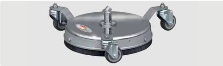
Das Knickmoment des Keramik-Drehgelenks ist variabel einstellbar und ermöglicht somit eine ermüdungsfreie Reinigung auf Böden und an Wänden. Es werden 2 Düsen 1/4" AG benötigt. 3 Lenkrollen (60 mm) Max. 1.800 l/h / 120 °C
