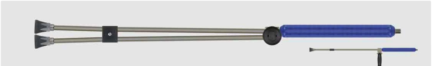
1/4" AG. Strahlrohr mit umspritzter Isolierung, Ventil ST-154 seitlich und Düsenschutz ST-10 mit Niederdruckdüse & Muffe 1/4" IG. Max. 500 bar / 150 °C
