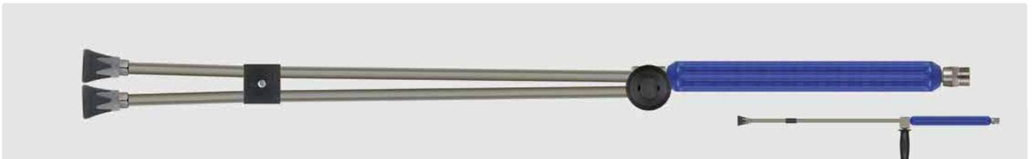
M22 AG. Strahlrohr mit umspritzter Isolierung, Ventil ST-154 seitlich und Düsenschutz ST-10 mit Niederdruckdüse & Muffe 1/4" IG. Max. 500 bar / 150 °C
