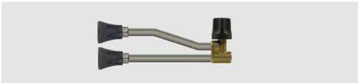
1/4" IG. Strahlrohr mit Ventil ST-53 oben und Düsenschutz ST-10 mit Niederdruckdüse & Muffe 1/4" IG. Max. 250 bar / 150 °C
