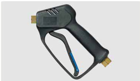
Professionelle Pistole. Weepausführung. Max. 210 bar / 25 l/min / 150 °C
