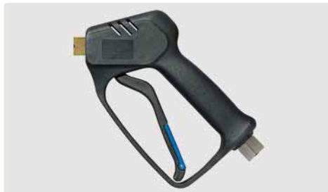
Professionelle Pistole. Weepausführung. Max. 210 bar / 25 l/min / 150 °C
