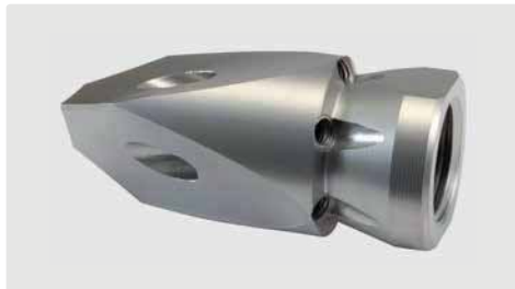
350 bar. 1/2" IG. Für Rohre > 60 mm. Seitliche Frontstrahlen mit gehärteten Edelstahl Düseneinsätzen.
