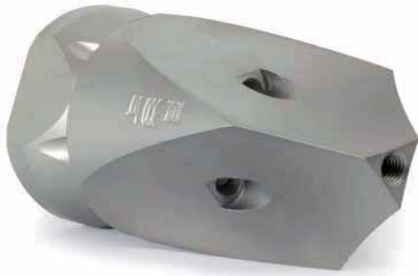
350 bar. 1/4" IG. Für Rohre > 30 mm. Seitliche Frontstrahlen 0,5 mm gebohrt.
