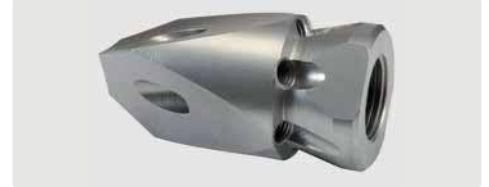
350 bar. 3/8" IG. Für Rohre > 50 mm. Seitliche Frontstrahlen mit gehärteten Edelstahl Düseneinsätzen.
