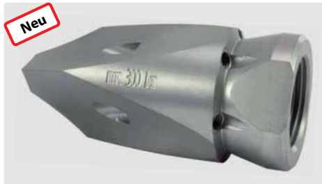
300 bar. 3/4" IG. Für Rohre > 80 mm. Seitliche Frontstrahlen mit gehärteten Edelstahl Düseneinsätzen.
